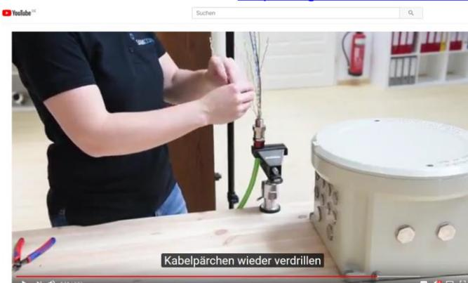
Bild 5-9 Ex-d Barriereverschraubung
