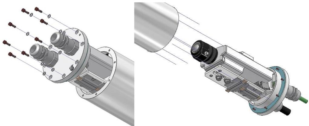
Bild 6-3 Öffnen der ExCam IPQ1715 (Abb. ähnlich)
