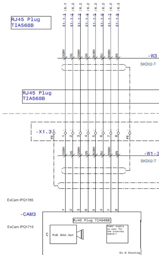
Bild 5-5 Musterbeschriftung des Klemmkastens ExTB (ohne Heizung)
