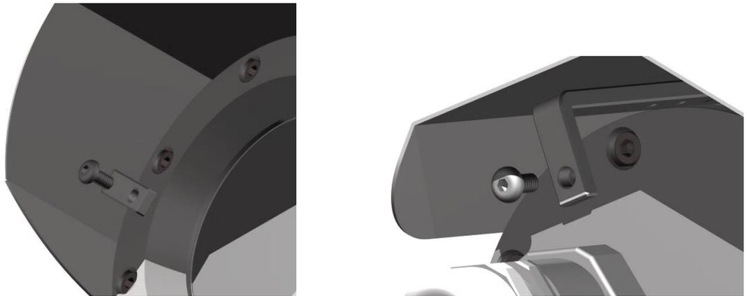
Bild 6-1 Entfernen des Wetterschutzdaches (1/2) (Abb. exemplarisch)
