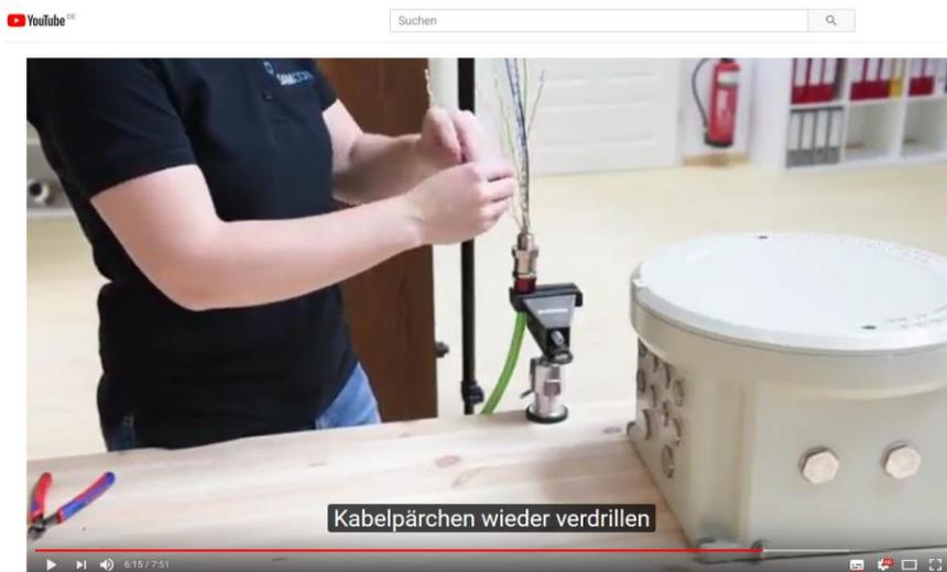
Bild 5-11 Ex-d Barriereverschraubung
