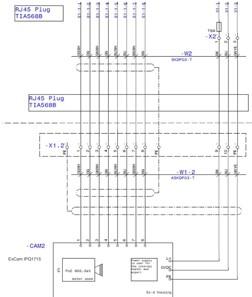
Bild 5-6 Musterbeschriftung des Klemmkastens ExTB (mit Heizung, armiert)
