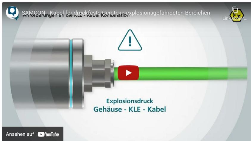
Bild 5-10 Ex-d Auswahl von Kabel
