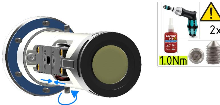
Bild 6-7 Einbau des neuen LED-Blocks
