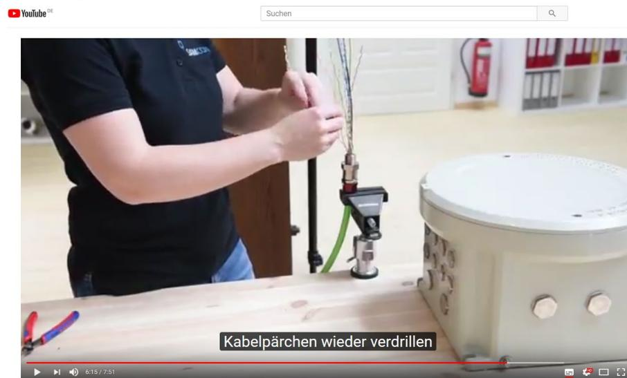
Bild 5-10 Ex-d Barriereverschraubung
