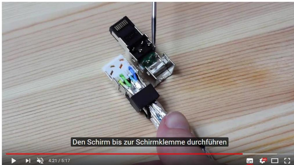
Bild 5-10 Stecker Belegung RJ45
