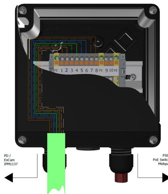
Bild 5-8 Foto des belegten Klemmkastens ExtB-2
