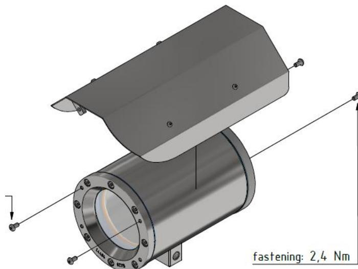
Bild 6-1 Entfernen des Wetterschutzdaches
