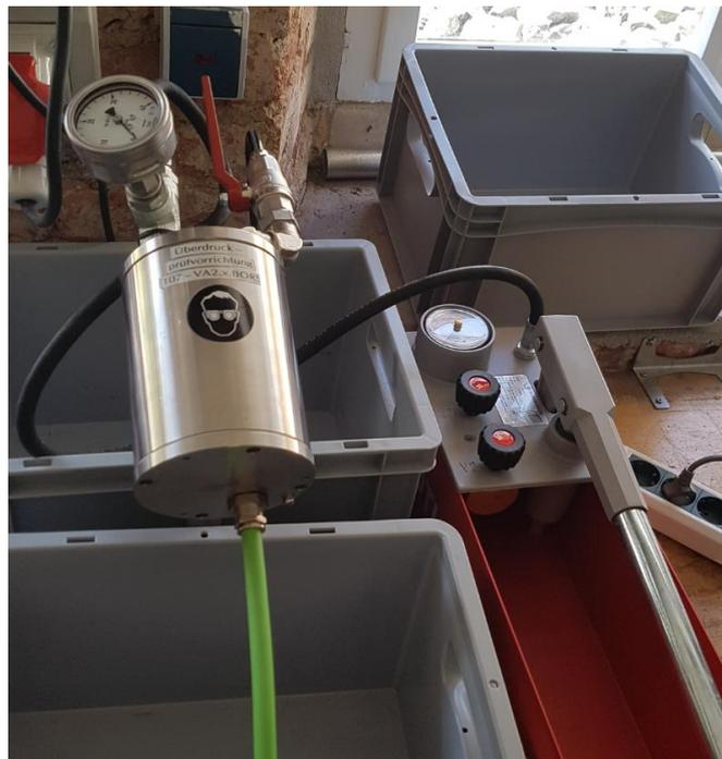
Bild 2-3: Druckprüfvorrichtungen für Kabel-KLE Kombinationen
